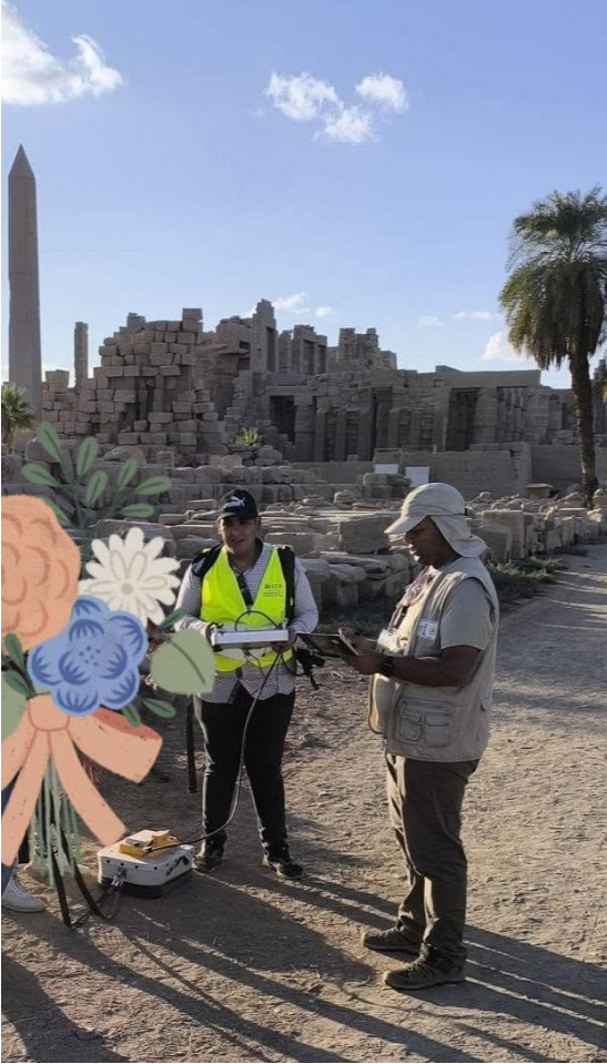
فريق العمل أثناء مسح الرادار الأرضي بالقرب من المسلة داخل معبد الكرنك.
