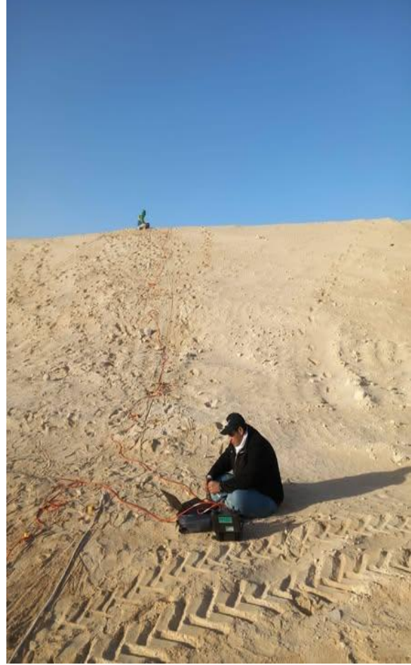
تسجيل الإشارات السيزمية عبر جهاز الاستقبال الموصول بخط الجيوفونات.
