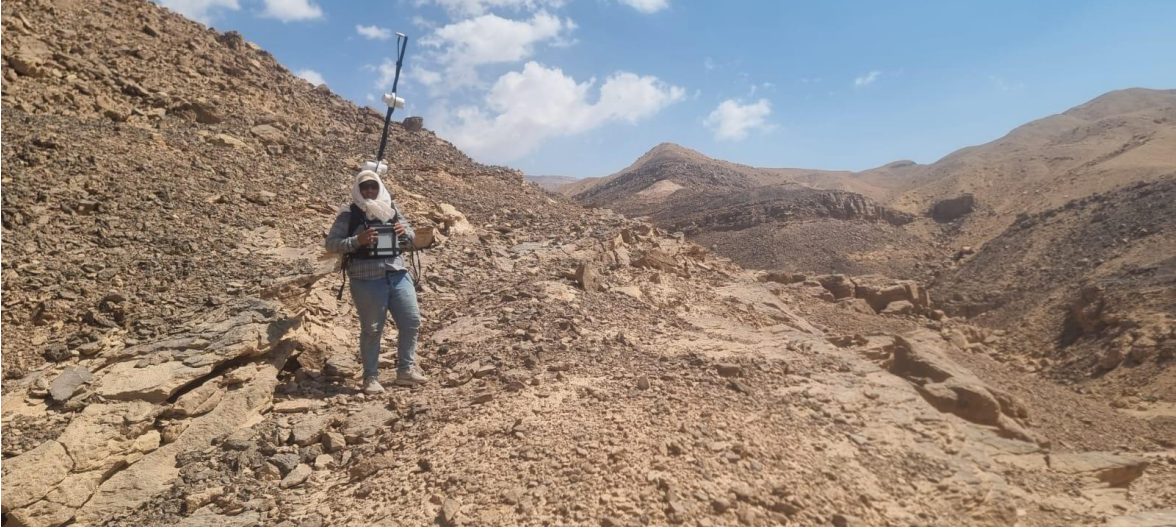
مسح مغناطيسي في التضاريس الجبلية بمنطقة الزعفرانة لرصد مناطق الصدوع القصية.
