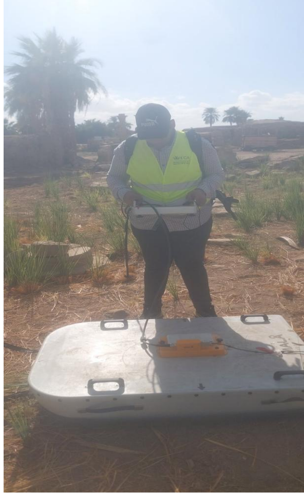
تشغيل عربة رادار الاختراق الأرضي لتصوير الطبقات تحت السطحية بموقع المعبد.
