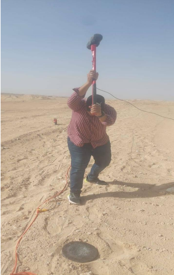
توليد الموجات السيزمية باستخدام المطرقة الاهتزازية كمصدر للإشارة.
